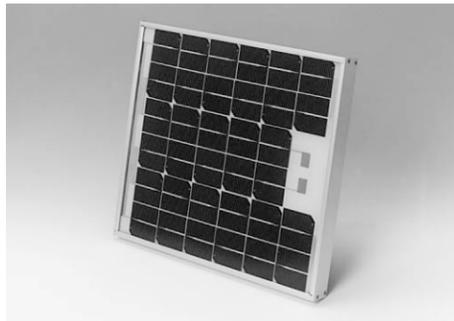
103mm角の1/4分割セルを34枚接続したモジュールです。10Wクラスの汎用モジュールとしてあらゆる小型システム(交通標識、無線等)に適用できます。
