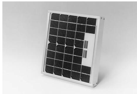
103mm角の1/6分割セルを18枚接続したモジュールです。6V系の小型システム用モジュールです。
